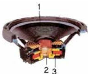
Le principe d'émission sonore de ces plaques vibrantes est assez similaire à celui d'un haut-parleur classique. Dans le cas d'un haut parleur le moteur transforme l'énergie électrique en énergie mécanique qui la transmet à la membrane. La membrane transmet à son tour l'énergie mécanique à l'air qui se met en vibration et restitue le son. Dans le cas du Métaphone®, la membrane a été remplacée par une plaque de bois en mélèze. C'est elle qui, mise en vibration, joue le rôle d'émetteur du son.
